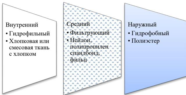
Рисунок 1. При условии использования в конструкции немедицинских масок нескольких слоев воздухопроницаемых тканей, таких как хлопок, смесовые ткани с хлопком, полиэфир, нейлон и полипропилен типа спанбонд может достигаться необходимый уровень фильтрации. Допускается изготовление однослойных или двухслойных масок из усовершенствованных материалов при условии их соответствия необходимым рабочим характеристикам (72).
